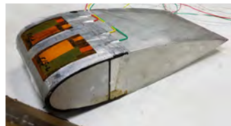
Film chauffant intelligent sur maquette de bord d'attaque d'aéronef.
